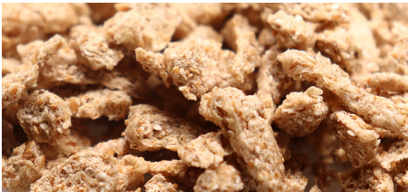
↑ Expandat issu de l'expandeur à couronne KAHL
