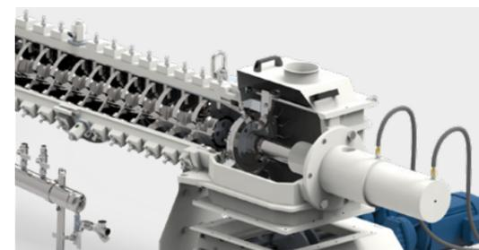
El expander consta de un tubo mezclador de paredes gruesas con dispositivos recambiables de desgaste y con un eje alojado en voladizo, que está provisto de elementos dosificadores, mezcladores y amasadores. El cono accionado hidráulicamente forma la abertura anular patentada con el anillo de salida, por lo que el expander KAHL también se denomina expander de abertura anular.
